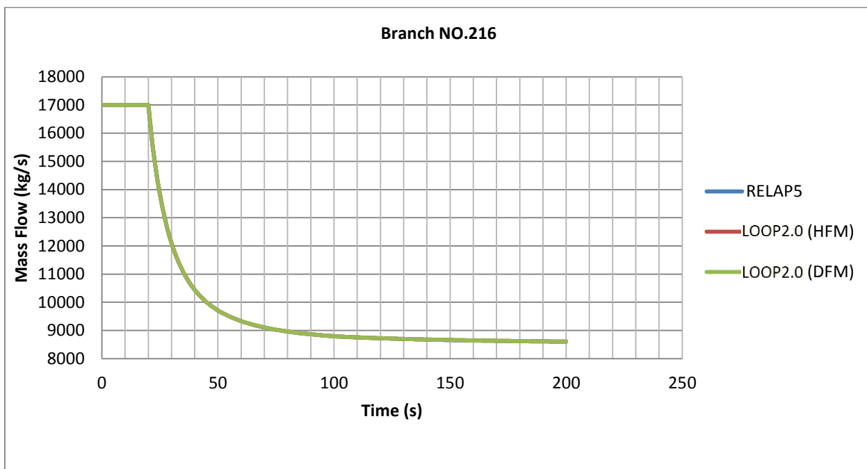
شکل ۷۸: تغییرات دبی سیال در ورودی قلب راکتور در حالت خاموشی دو پمپ
