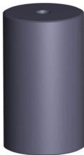
شکل ۱۷: قرص سوخت با حفره مرکزی
